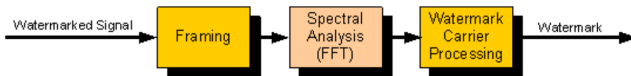
Figura 30: Processo di estrazione del watermark
