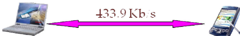
Fig 1.2 – Canale asincrono con connessione simmetrica.
