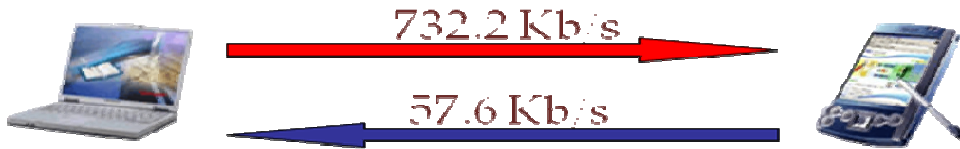
Fig 1.3– Canale asincrono con connessione asimmetrica.
