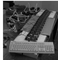
Per questo motivo si è reso necessario realizzare il cracker in Hardware usando degli FPGA, ossia dei circuiti programmabili, ognuno avente 32 core processors.
